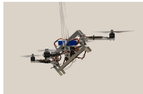
本研究室で設計したチルトするクアッドロータヘリ
